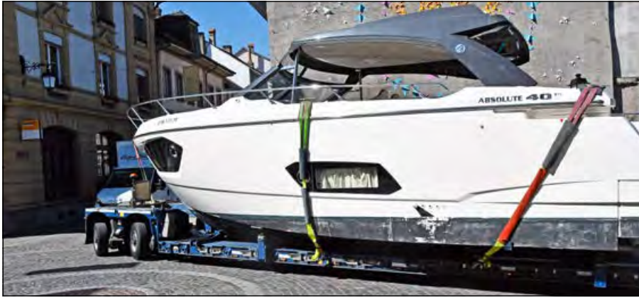
Lenkachsen des Faymonville-Tiefgängers: Sie erleichterten es, den Spezialtransport durch schwierige Passagen zu steuern, die «Schumi» während des Transports bewältigen musste.
